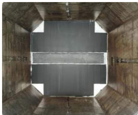
Figure 1 : Module solaire céramique au sein de la cavité de la centrale solaire THEMIS
